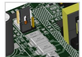
Alterar strap (CN5) conforme imagem acima para tensão 220V
